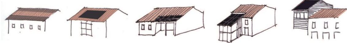
Exemples d'intégration des panneaux sur un bâtiment d'habitation existant : en bande sur toute la longueur de toiture, centrée sur l'axe d'une ouverture, sur une serre, un auvent, une véranda, sur toute une partie de l'habitation ...
